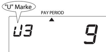
Die "U" Marke auf der linken Seite der Anzeige zeigt an das die Einstellung mittels des USB-sticks vorgenommen wurde und daher nicht mit den Tasten geändert werden kann.
