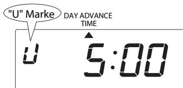
Die "U" Marke auf der linken Seite der Anzeige zeigt an das die Einstellung mittels des USB-sticks vorgenommen wurde und daher nicht mit den Tasten geändert werden kann.
