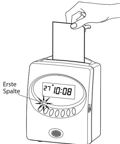
Das Gerät stempelt immer in die Spalte die mit der leuchtenden Lampe indiziert wird.
