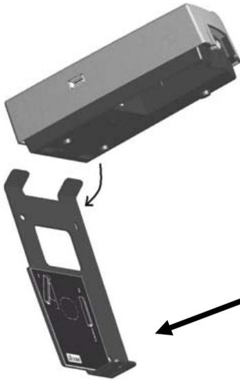
Befestigen Sie die Oberseite des Terminals mit Hilfe der zwei oberen Zentrierzapfen mit der Wandhalterung.
