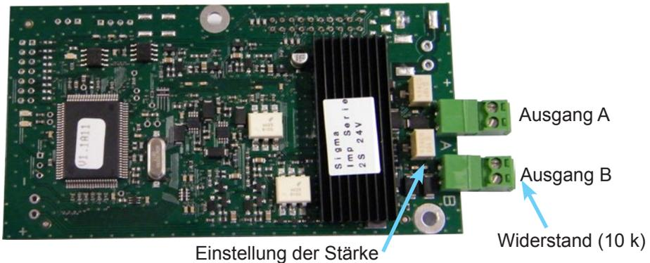
Diese optionale Karte erfordert keinerlei Parametrierung. Die standardmäßig eingestellte Uhrzeit ist die in der Sigma definierte Ortszeit mit Impulsen von 1,2 Sekunden; die Leitung ist ausgeschaltet).
