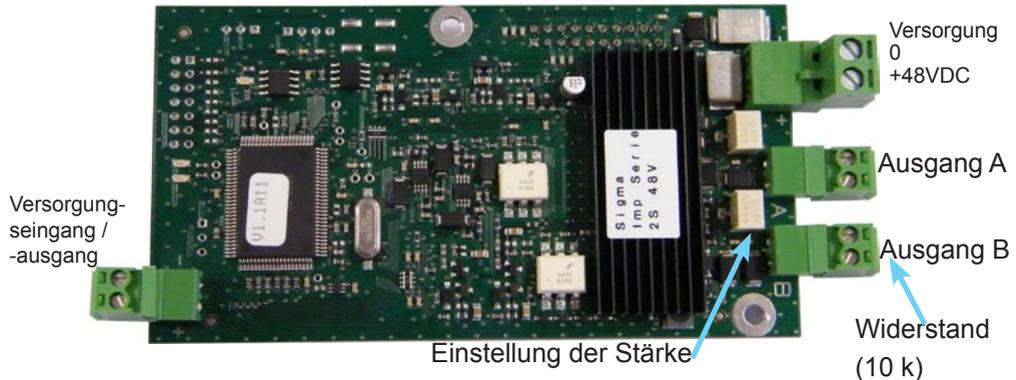
Diese optionale Karte erfordert keinerlei Parametrierung. Die standardmäßig eingestellte Uhrzeit ist die in der Sigma definierte Ortszeit mit Impulsen von 1,2 Sekunden; die Leitung ist ausgeschaltet).
