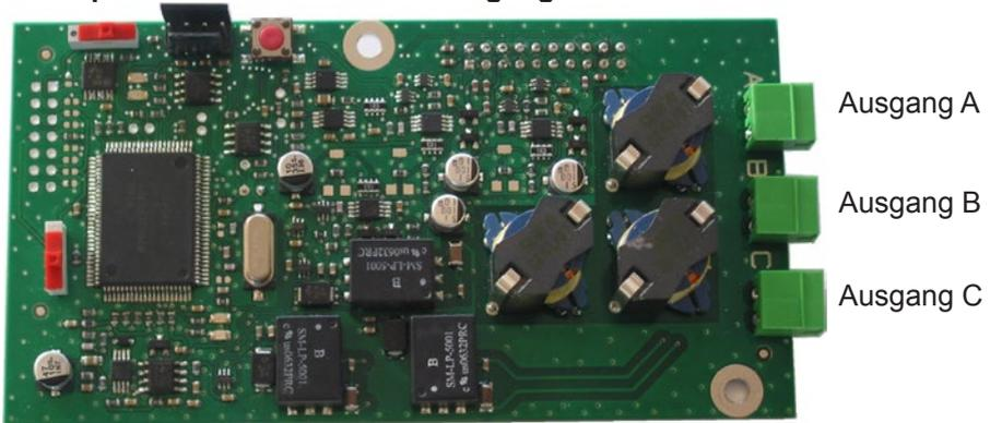
Diese optionale Karte muss nicht über die Software parametrieren werden (die standardmäßig eingestellte Uhrzeit ist die in der Sigma definierte Ortszeit und die Leitung ist ausgeschaltet). Im Techniker-Menü „Zeitausgänge“ müssen lediglich die Zeitverschiebung und der Leitungszustand (Ein/Aus) festgelegt werden (siehe Seite 38).
