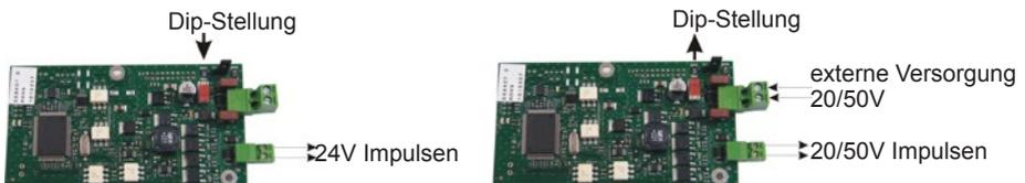
Der Jumper ermöglicht die Ausgangsleistungseinstellung.
