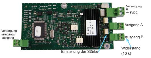
Diese optionale Karte erfordert keinerlei Parametrierung. Die standardmäßig eingestellte Uhrzeit ist die in der Sigma definierte Ortszeit mit Impulsen von 1,2 Sekunden; die Leitung ist ausgeschaltet).
