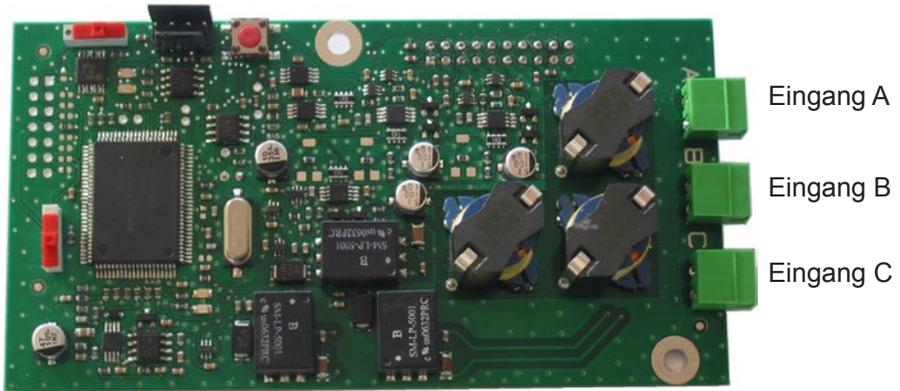
Diese Karte ermöglicht das Hinzufügen von 3 externen Eingängen.
