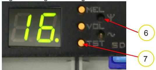
Nach der Initialisierung des Empfängers ist die DHF-Led (6) zunächst rot und wird dann nach Empfang der DHF Glockenspiel-Steuerungsbefehle der Hauptuhr grün.
