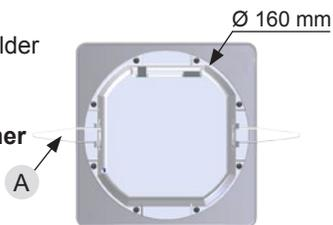
2/ Bringen Sie den Harmonys Melder zur Deckenmontage an seinem Platz an, das Ethernet-Netzwerk wird mit der Buchse RJ45 verbunden.
