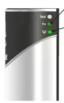
eingeschaltet: Netzteil OK ausgeschaltet: kein Netzteil.
