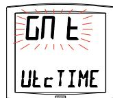
Die Einstellung des Unterschieds wird durch einen Druck auf die Taste [+] geführt. Der Wert kann zwischen -12:30 und +12:30 liegen mit Schritten von 0:30. Angezeigte Uhrzeit = GMT Uhr + oder - x Stunden.
