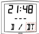
“WO” Welt Funktion, diese Option ermöglicht die Anzeige eines Städtenamens auf der unteren Anzeige. Durch einen Druck auf die Taste [Sel] bestätigen.
