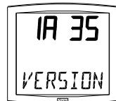
3. Appuyer sur le bouton [SELECT] pour afficher le menu du type de synchro (en fonction de la version). La touche [+] permet le choix entre *Ind* et *Sync* (si la carte synchro est présente) ou *Ind*, *DHF* et *DHFi*.
