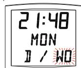
a) Das erste Zeichen ist mit Hilfe der Taste [+] und einer Bestätigung mit Hilfe der Taste [Sel] ausgewählt..
