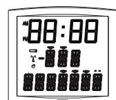
7. Appuyer sur [SELECT]. Le menu *Correction* s'affiche. Il permet de corriger manuellement la base de temps. En sortie d'usine, la valeur de l'offset (correction) est de 0. La valeur de cet offset peut varier (à l'aide de [+]) entre -9s99 et +9s99 par pas de 10ms (#0.12ppm). L'ajout de cet offset journalier à la base de temps sera réparti sur 24 heures.
