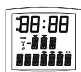
7. Die Taste [SELECT] drücken. Das Korrektur Menü erscheint. Es ermöglicht die Basiszeit manuell einzustellen. In der Fertigung ist die Temperatur auf 0 eingestellt. Die Taste [+] drücken, um den Wert der Einstellung von -999 bis +999 mit Schritten von 10ms (#0.12ppm) zu schwanken. Die Einstellung der Temperaturbasis wird auf einer Periode von 24 Stunden durchgeführt.
