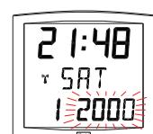
b Die Taste [+] bis zur gewünschten Minute drücken. Um die Uhr auf die Sekunde genau zu synchronisieren, die laufende Minute +1 auswählen und beim Ton der Minute durch einen Druck auf [Sel] bestätigen ; Der Sekundenzähler wird auf Null gestellt und startet.
