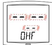
*Init* : force l'horloge à rechercher un émetteur DHF.
