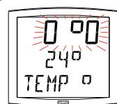
6. Die Taste [SELECT] drücken, um das Menü Test Anzeige zu halten. Die Anzeige aller Segmente der Uhr können Sie mit diesem Menü prüfen. Auf der Cristalys Date Uhr ist es möglich mit der Taste [+] die Zeichentabelle durch zu blättern.
