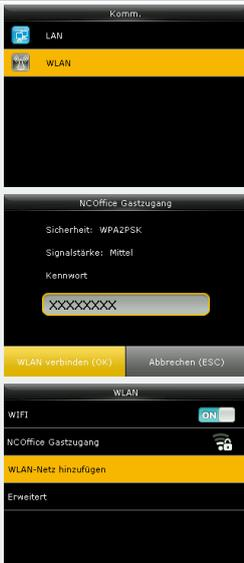
**WIFI:** WLAN-Netz aktivieren oder deaktivieren. Anschließend das gewünschte WLAN-Netz auswählen und mit diesem verbinden.
