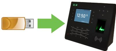
1. Stecken Sie einen USB-Speicher in den USB-Anschluss an der linken Seite des Terminals.
