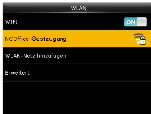
5. Sie werden aufgefordert, das zugehörige Kennwort für das WLAN-Netz einzugeben. Tragen Sie das Kennwort ein. Weitere Informationen zum Eintragen von Text im Abschnitt [Text, Ziffern, Sonderzeichen eintragen](#).
