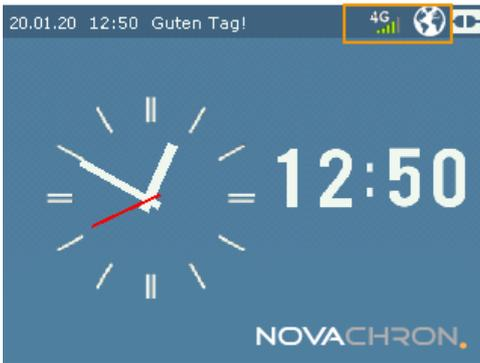
Das Terminal sendet alle 60 Sekunden einen Datensatz an die IP-Adresse des Webservers. Nach erfolgreichem Datenempfang sendet der Webserver eine Rückmeldung an das Terminal (erscheint im Protokoll). Konnte die Buchung nicht übertragen werden, wird der Verbindungsaufbau so lange weitergeführt, bis die Buchung an den Webserver übermittelt ist. Zusätzlich zur Datenübertragung wird jede Buchung zur Sicherheit gleichzeitig intern im Terminal abgespeichert.
