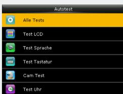
**Test Tastatur:** Sämtliche Tasten des Terminals überprüfen. Nach Drücken einer Taste, erfolgt bei der jeweiligen Taste auf dem Display ein vorübergehender Farbumschlag. Dieser zeigt an, dass die Taste ordnungsgemäß funktioniert.
