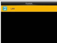
**IP-Adresse:** Standard-IP-Adresse des Terminals ist 192.168.1.201. Diese muss gegebenenfalls an die Netzwerkeinstellungen angepasst werden.
