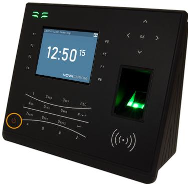
1. Drücken Sie die Ein-/Aus-Taste
