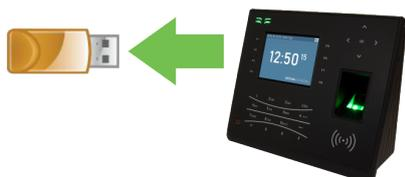
1. Stecken Sie einen USB-Speicher in den USB-Anschluss an der linken Seite des Terminals.
