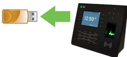
Verfügen Sie über keinen Zugang zu einer Netzwerkverbindung oder Sie können das Terminal nicht in Ihrem Netzwerk integrieren, haben Sie die Möglichkeit, mit einem USB-Speicher Benutzer- und Anwesenheitsdaten vom Terminal abzurufen.
