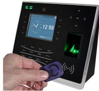
Wurde der Transponder bzw. die Karte akzeptiert, erscheinen auf dem Display die Benutzer-ID, der Name des Mitarbeiters und die Bestätigung der Prüfung „Danke“. Nach erfolgreicher Überprüfung wird die Buchung mit Benutzer-ID, Name, Datum/Uhrzeit und Buchungsmedium im Terminal gespeichert.
