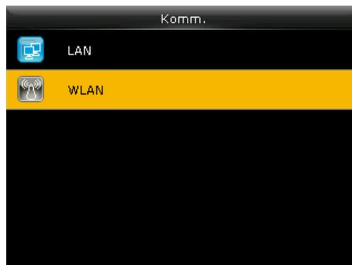
3. Drücken Sie [OK] für ON, um **WIFI** zu aktivieren. Es wird eine Übersicht aller verfügbaren WLAN-Netze angezeigt.
