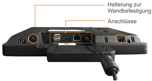
1. Lösen Sie die Schrauben an der Geräteunterseite des Terminals und nehmen Sie die Wandhalterung ab.
