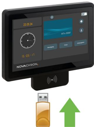
Verfügen Sie über keinen Zugang zu einer Netzwerkverbindung oder Sie können das Terminal nicht in Ihrem Netzwerk integrieren, haben Sie die Möglichkeit, mit einem USB-Speicher Buchungsdaten vom Terminal abzurufen.
