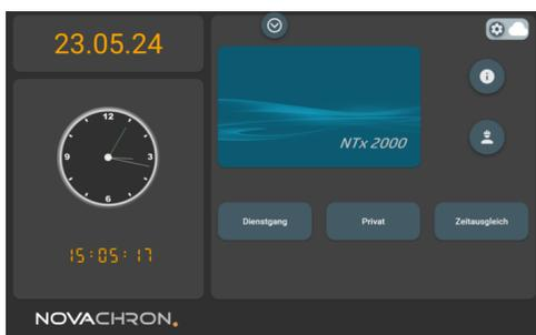
2. Melden Sie sich mit dem Ihnen zugeordneten Identifikationsmedium (Transponder, Fingerabdruck [NTB] oder Passwort) am Terminal an.
