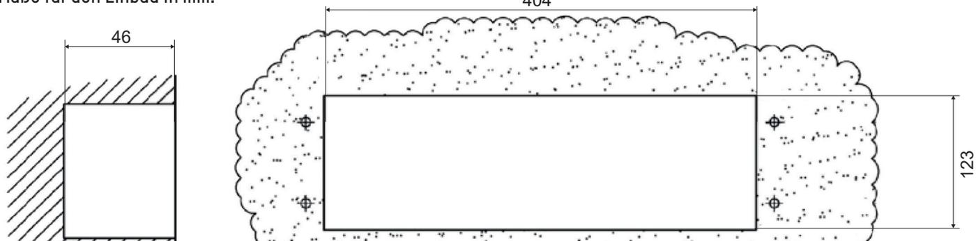
Maße der hintergrundplatte zur Einbauausführung in mm:
